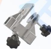
圖 1.2. 保定吊桿固定夾頭
